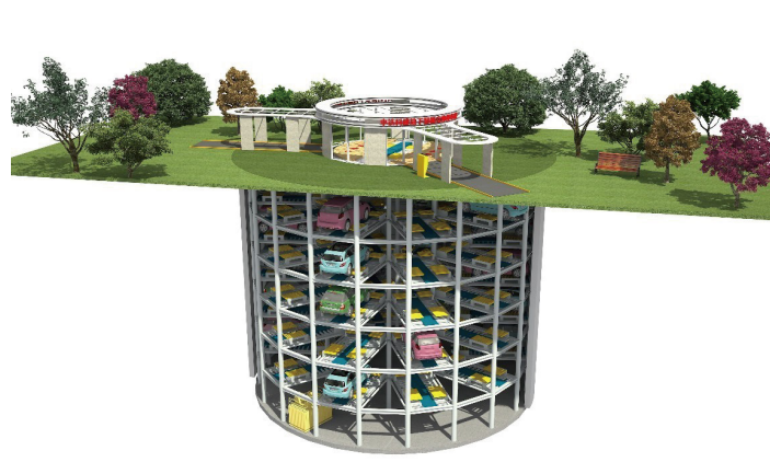
地下停车场 直径20米，深度50米，可停车20层，每层10-12辆，存取车时间60秒
