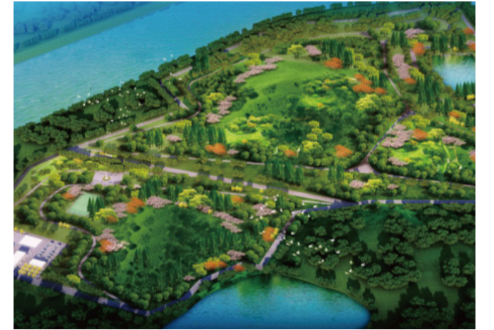
武汉市紫霞观生活垃圾填埋场生态修复工程 承担污染物治理工作，采用污染物屏障技术、换土技术
